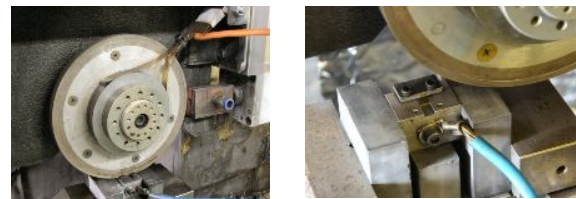
図4 放電複合研削セットアップ
